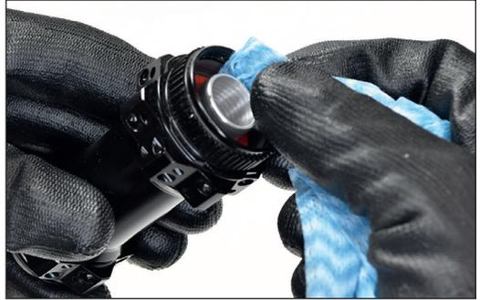
3. Freiliegende Kugellager und Innenseite beider Endanschlage fetten.
