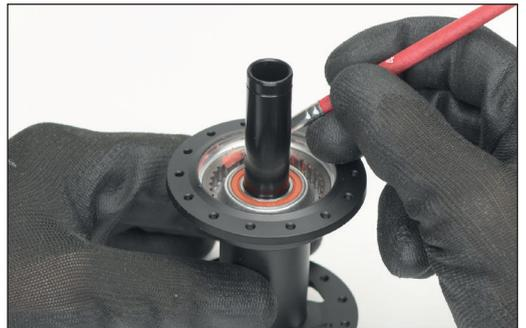
4. Fette die Außenfläche des Kugellagers und die Dichtfläche der Rotordichtung an der Nabe mit Universalfett.
