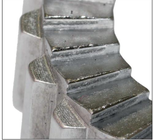
3. Freilaufkörper auf Beschädigungen wie Risse etc. prüfen.
