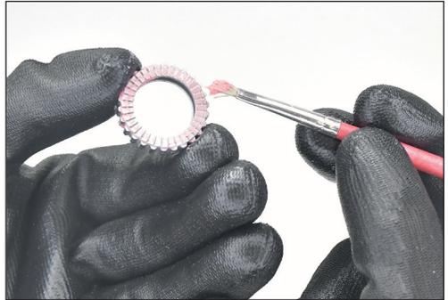
2. Verzahnung des Freilaufkörpers und des Gewinderings mit DT Swiss Spezialfett fetten.
