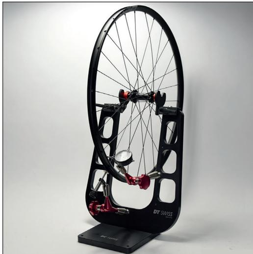
Als Grundlage für die folgenden Schritte wird angenommen, dass die Speiche gebrochen ist. Ist die zu tauschende Speiche noch intakt, kann diese mit einem Seitenschneider o.ä. getrennt werden.
