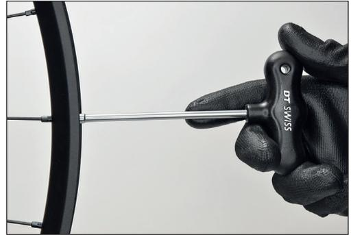
Mit Hilfe des DT Swiss Nippelspanners kann der Nippel auf der Felgenaußenseite gedreht werden. Dies ist die gängige Methode bei:
