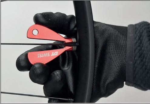
Mit Hilfe des DT Swiss Spokey kann der Nippel auf der Felgeninnenseite gedreht werden. Diese Methode ist besonders nützlich bei:
