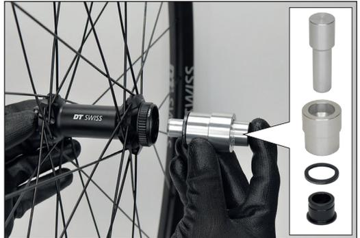
4. Abdeckung auf das Nabengehäuse aufschlagen.
