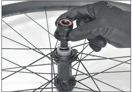
3. Freiliegende Kugellager und Innenseite beider Endanschlätze fetten.
