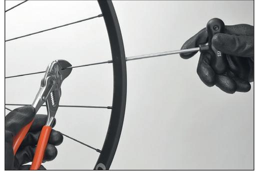
Rundspeichen müssen während des Spannens und Lösen des Nippels gehalten werden. Dies kann mit einer kleinen Flachzange oder einem ähnlichen Werkzeug geschehen. Wichtig ist es hierbei darauf zu achten, dass die Speiche nicht beschädigt wird und nicht verkratzt.
