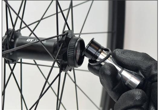
5. Beide Endanschlüge und Kugellager mit einem trockenen Tuch reinigen.
