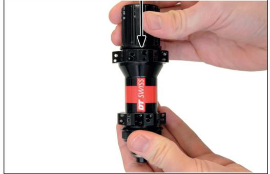
3. Beide Kugellager und Innenseite der Endanschläge ([Abbildung 2/1/13](#)) fetten.
