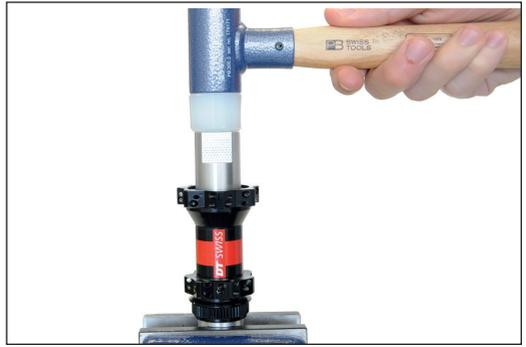
8. Achse ([Abbildung 2/3](#)) aus dem Nabengehäuse herausnehmen.
