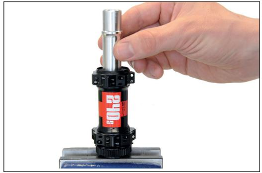
4. Kurze Montagehülse auf die Achse schieben.
