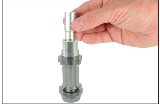
6. Zweites Kugellager (Abbildung 1/2) mit Hilfe des Demontagewerkzeugs und einem Hammer aus dem Nabengehäuse herausschlagen.
