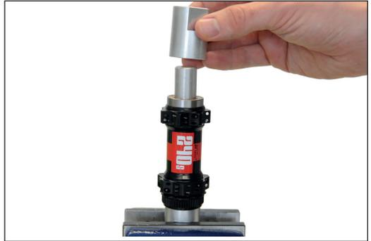
13. Zweites Kugellager mit leichten Hammerschlägen in das Nabengehäuse einschlagen.
