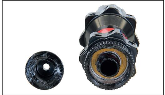
4. Rechten Endanschlag ([Abbildung 2/13](#)) und linken Endanschlag ([Abbildung 2/1](#)) auf die Nabe aufstecken.
