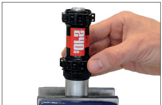
9. Bremsseite der Nabe mit Achse auf die Montagehülse aufstecken.
