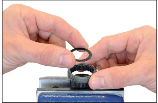
4. Nabe auf das Tool aufsetzen und Gewinding ca. 2 Umdrehungen aufschrauben.
