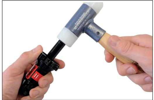
2. Kugellager von der Achse abnehmen.
