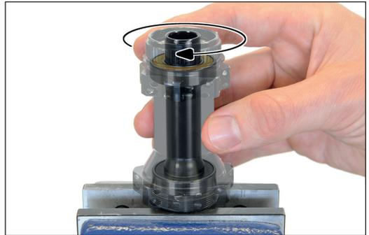
5. Gewinding-Werkzeug ausspannen, 90° drehen und in der hohen Position wieder in den Schraubstock einspannen.
