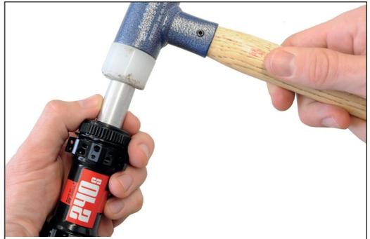
3. Achse in das Nabengehäuse einstecken.
