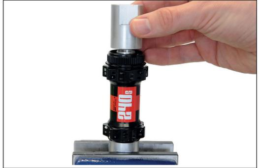
7. Kugellager mit leichten Hammerschlägen in das Nabengehäuse einschlagen.
