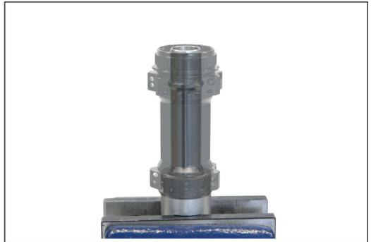
5. Leicht gefettetes Kugellager (Abbildung 1/2) mit der farbigen Seite nach aussen auf der Disc-Seite auf die Achse aufschieben.
