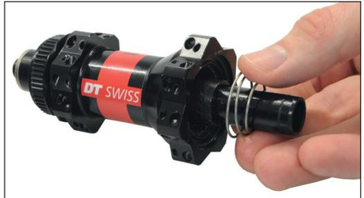
4. Beide Zahnscheiben (Abbildung 2/11) und die zweite Feder (Abbildung 2/10) anbringen.
