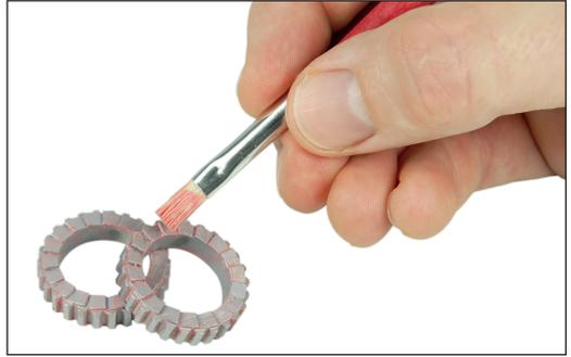
2. Verzahnung des Rotors und des Gewinderings mit DT Swiss Spezialfett fetten.
