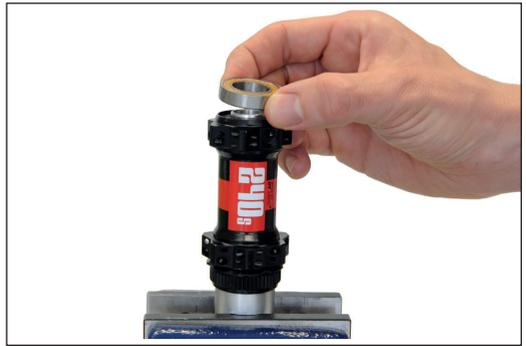
11. Demontagewerkzeug auf die Achse aufstecken.
