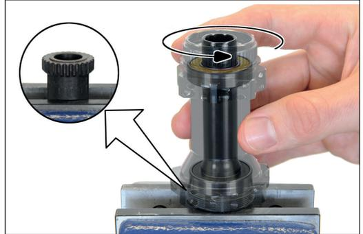
5. Gewinding (Abbildung 2/7), Dichtung (Abbildung 2/8) und Passscheibe (Abbildung 2/6) abnehmen.
