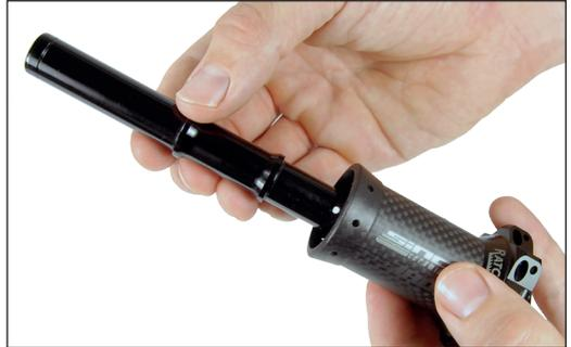
8. Eingepresstes Kugellager mit Universalfett fetten.
